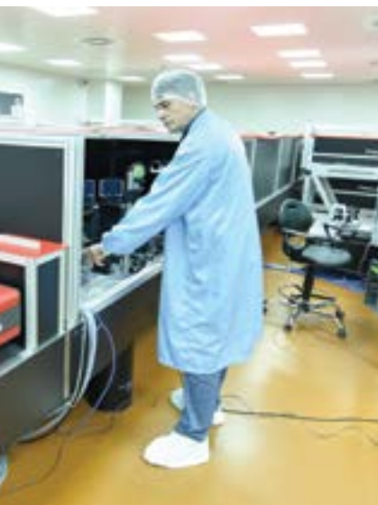
CETAL PW: Camera de interacție laser-țintă (incintă vidată, sisteme de poziționare ținte, focalizare cu oglinzi parabolice off-axis)
