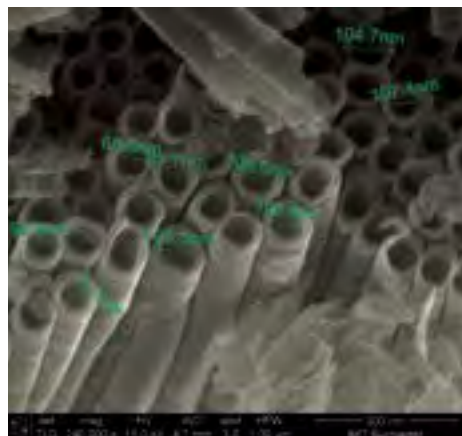
Micrografie SEM cu NT (nanotuburi) de \text{TiO}_2 obținute prin anodizarea foliei de Ti.
