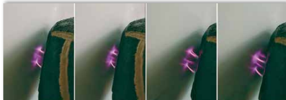
Figura 5 A...D. Aspectul descărcării electrice (plasmei) la ieșirea ajutorului, pe durata unui tratament pe suprafață Demo video: https://www.youtube.com/shorts/DKEIWGgqbOg
