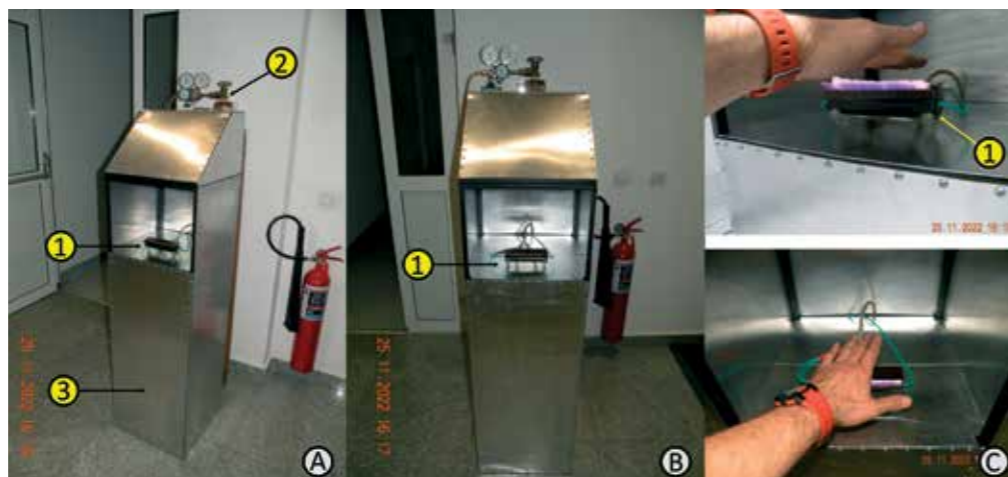
Figura 1 Instalația realizată la INCDTIM Cluj-Napoca, aflată în teste. Notațiile se referă la: (A) vedere laterală (B) vedere frontală (C) Instalația în teste de inactivare (1) aplicatorul de plasmă rece pentru dezinfectarea palmelor (2) butelia de gaz inert, (3) corpul principal al instalației
