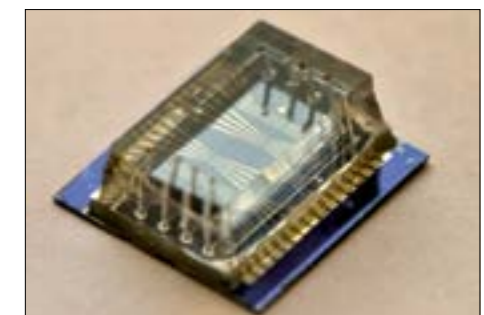
Dispozitiv magnetorezistiv prevăzut cu capcane magnetice pentru detecția de particule magnetice utilizate în aplicații biomedicale.
