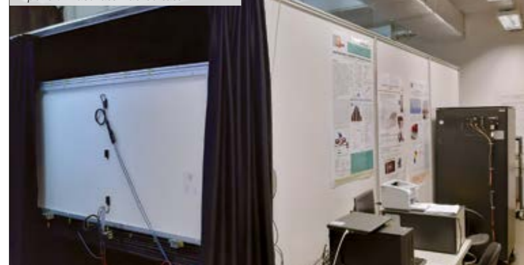
Stand de testare a modulelor fotovoltaice pentru măsurători acreditate RENAR
