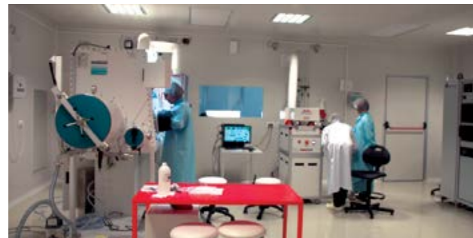
Imagine din camera curată, cu echipamentele de depunere de straturi subțiri din materiale semiconductoare cu bandă largă și material 2D-grafenă.
