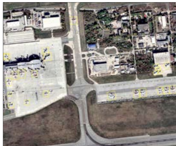
Analiză din domeniul inteligenței artificiale (dectecție de obiecte) - dectecția de avioane dintr-o imagine de rezoluție ridicată în zona Aeroportului Henri Coandă, Otopeni
