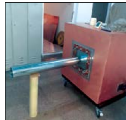
Fig 3. Testarea eficacității de ecranare electromagnetică a unui dispozitiv de protecție TEMPEST, tip ghid de undă, dezvoltat de un IMM
