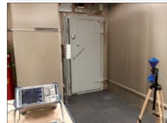
Fig 4. Testarea eficacității de ecranare electromagnetică a două încăperi protejate TEMPEST realizate de un IMM
