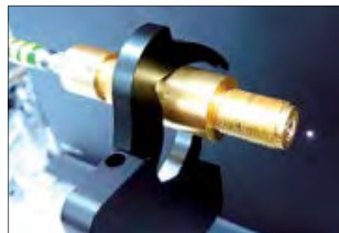
O bujie de tip laser realizată în colaborare cu Fraunhofer - IOF, Jena, Germany ('Team 2' și 'Laboratory Training 4').
