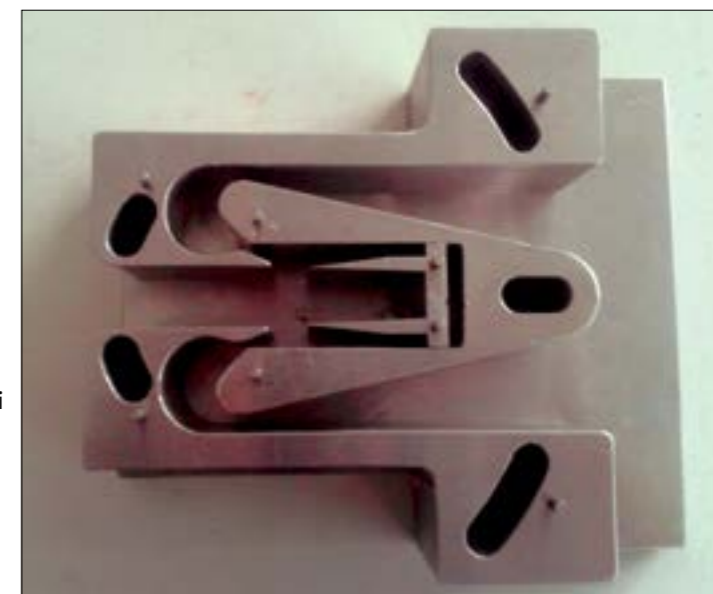
Prima variantă de motor cu detonație realizat la INCD Turbomotoare COMOTI în proiectul TIDE
