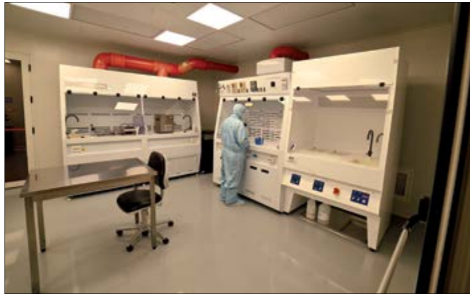
Cameră curată clasă ISO 5, din cadrul IMT MINAFAB, destinată procesărilor chimice
