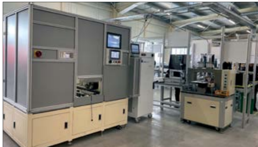
Celula pilot de procesare laser a tab-urilor din componența bateriilor electrice reîncărcabile amplasată pe linia de asamblare de la operatorul comercial
