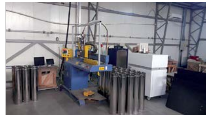
Procesarea laser în condiții reale de funcționare a elementelor metalice ce alcătuiesc coșurile de fum
