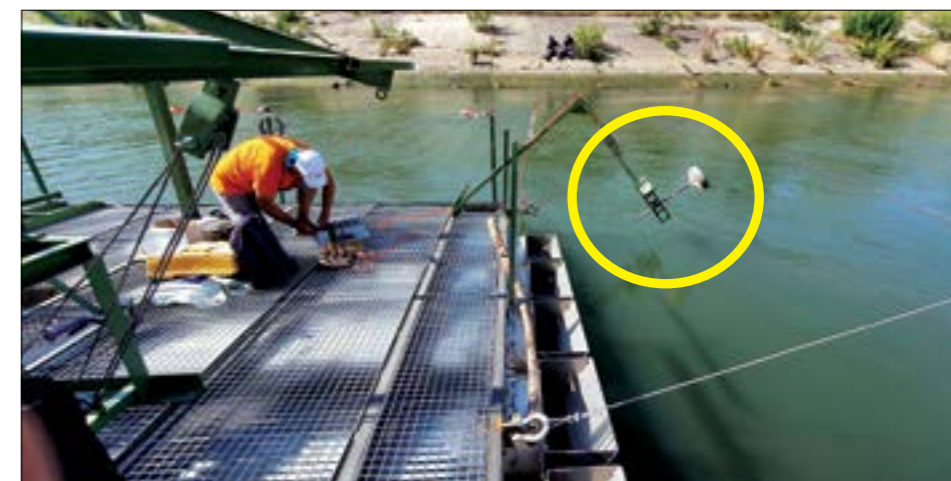
Testarea in situ a unui model de turbină hidrocinetice cu diametru de 200mm
