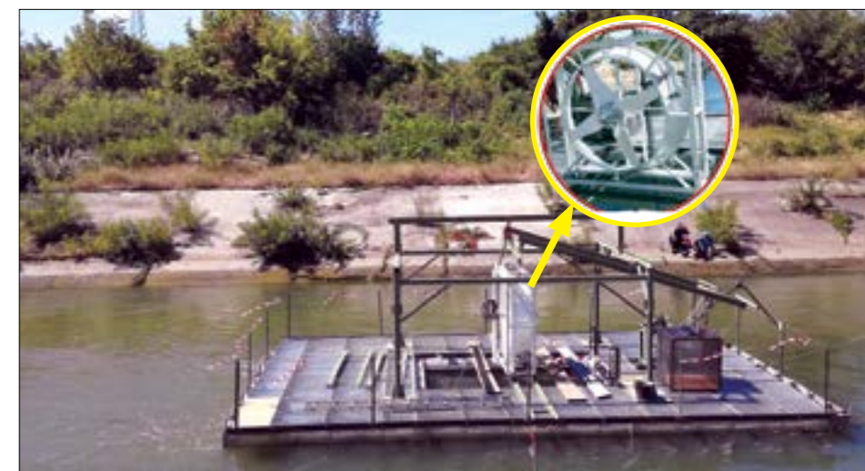
Testarea ansamblului turbină-generator în condiții reale de funcționare
