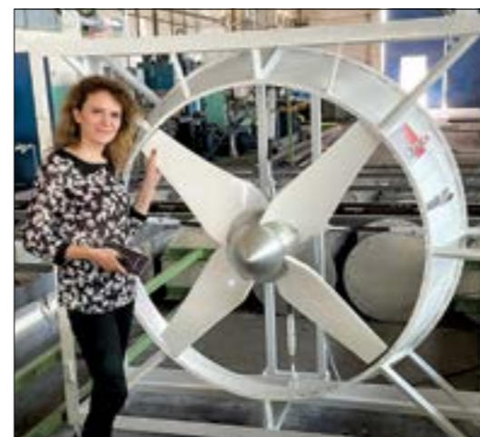
Turbina hidrocinetică MICROHIDRO dezvoltată de cercetătorii ICPE-CA în cadrul proiectului POC 2014-2020, P_40_432 / 105567
